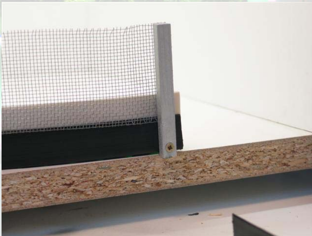
Fijación mecánica del primer poste a la base
